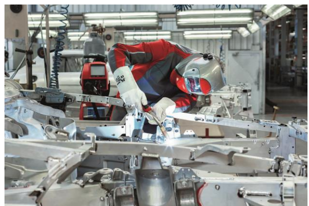
CMT (Cold Metal Transfer) Applikation auf einem Automobilgestell
